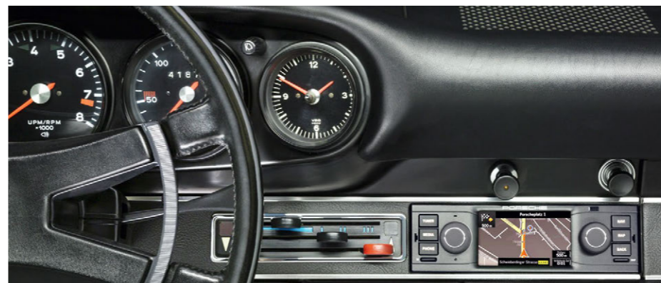
Für historische Fahrzeuge bieten die OEM aber auch Gerätehersteller auf dem freien Markt Ersatzlösungen inkl. DAB+-Empfang und Navigationsgerät an. Die Optik orientiert sich an klassische Geräte. Foto: Porsche
