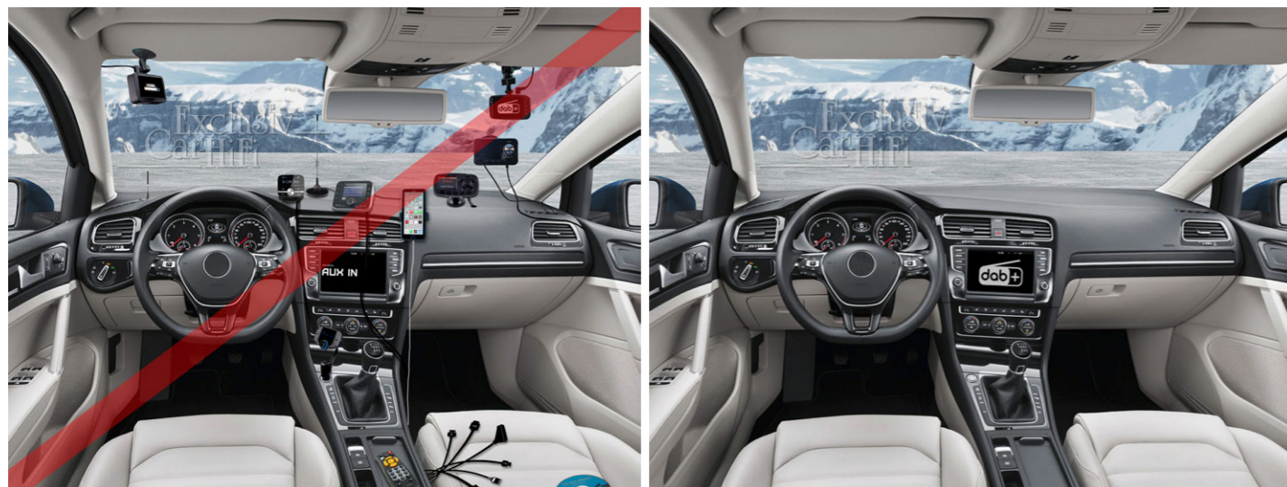
Für DAB+-Nachrüstlösungen gibt es verschiedene Möglichkeiten. Die beste Variante ist die Vollintegration in das bestehende Infotainment (rechts). Foto: Exklusiv Car-Hifi
