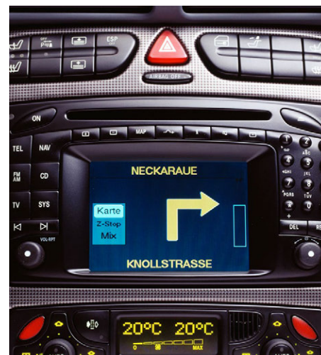
Solche Navigationsgeräte werden keine Verkehrs- informationen mehr verarbeiten können und Alternativ- routen vorschlagen: TMC entfällt nach Abschaltung der UKW-Sender. Foto: Mercedes-Benz
